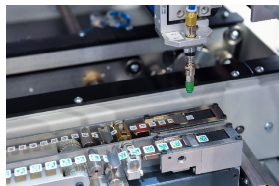
Kennzeichnung per Labelzelle mit zwei Label Feedern
