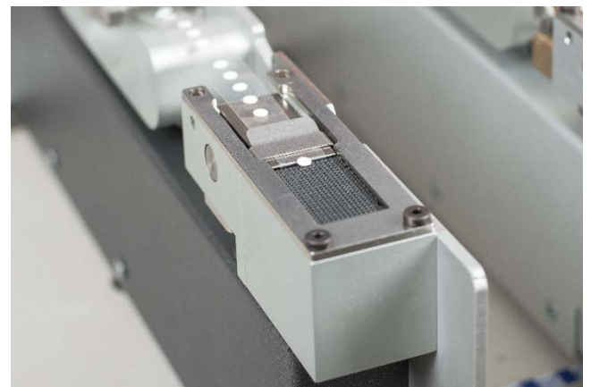
Zuführung eines Sensors von 3 mm Durchmesser
